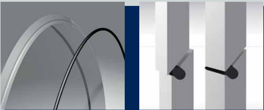
Dichtung und Schließvorgang einer Inspektionstür
